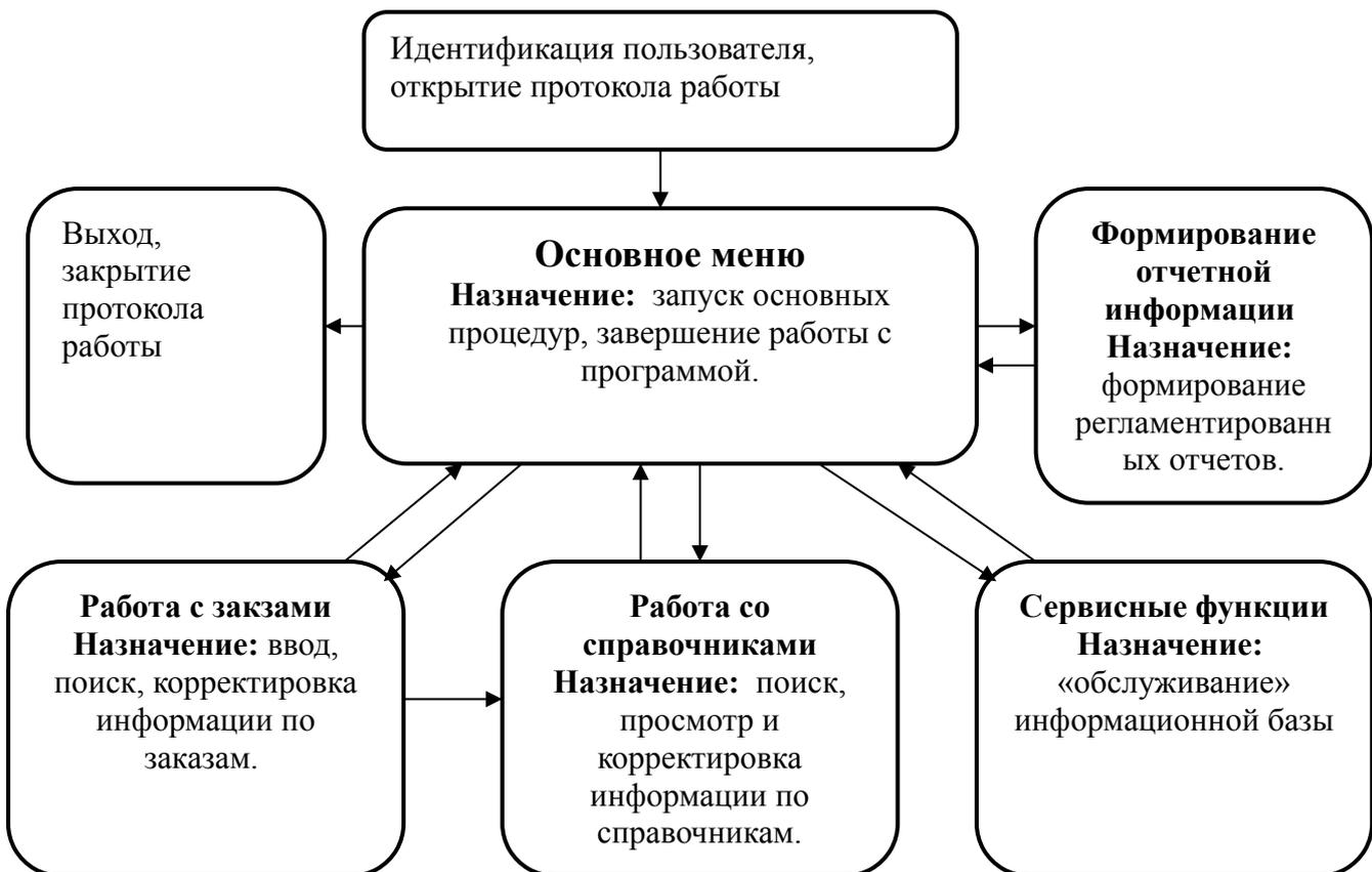
Рисунок 7 - Укрупненная блок-схема программы
